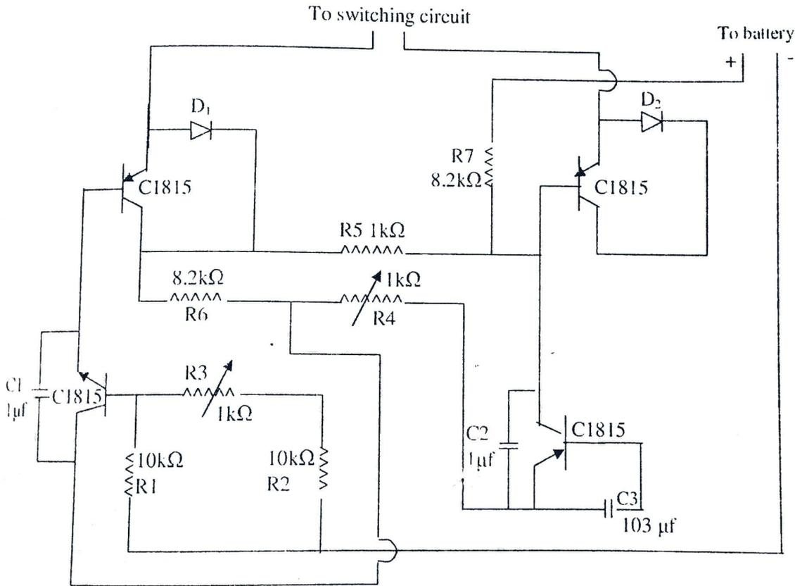
**Fig 2 : Pulse Generator Circuit.**
