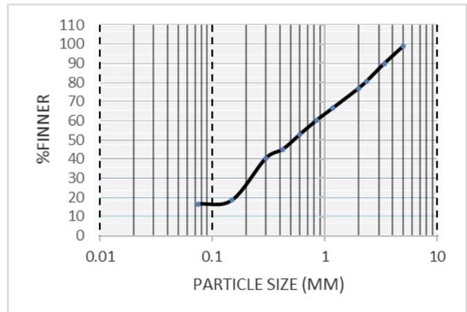
FIGURE 1B: PARTICLE SIZE DISTRIBUTION OF QUARRY FINES
