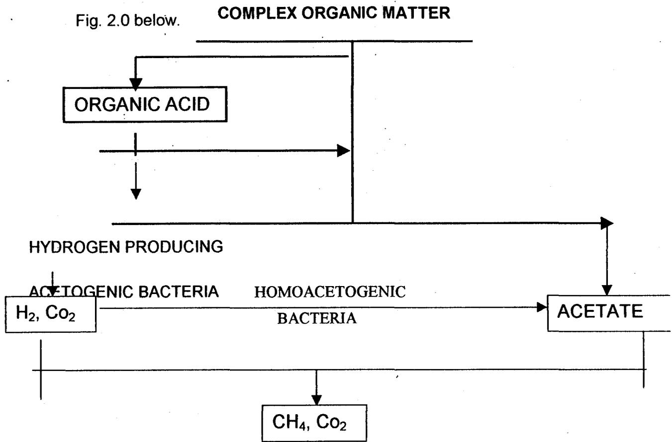
**Fig 2.0 SUCCESSIVE STAGES IN ANAEROBIC DIGESTION**
