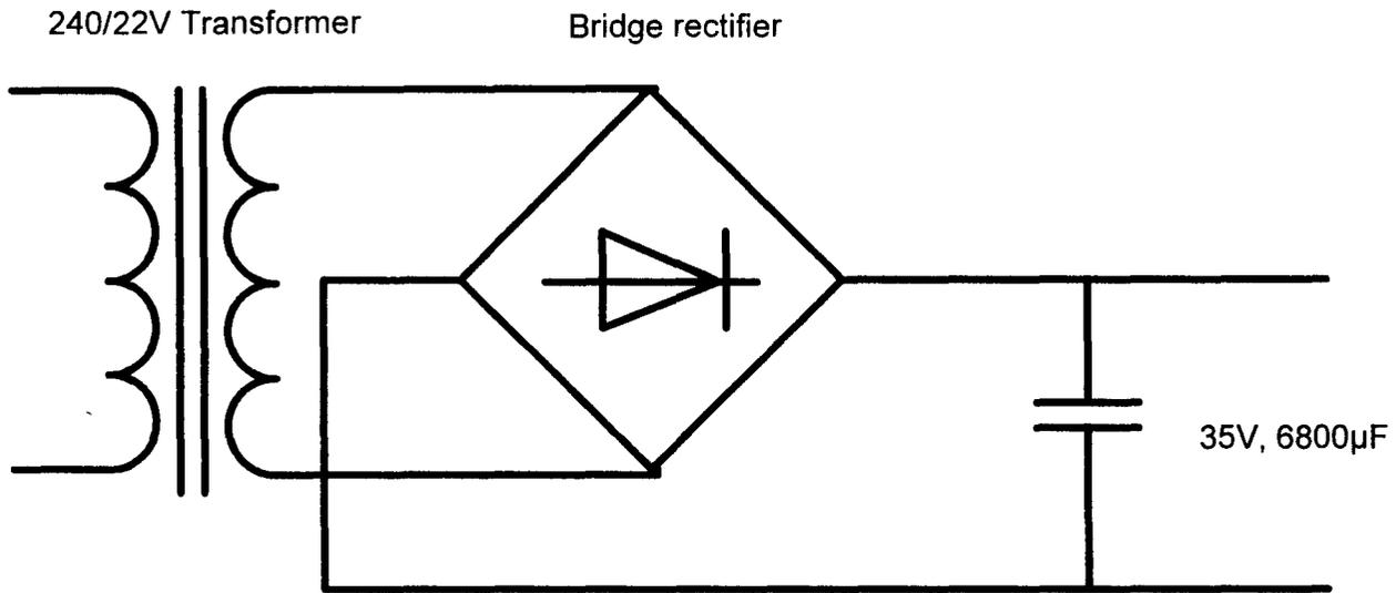
Fig. 3.1 AC Rectifier Circuit
