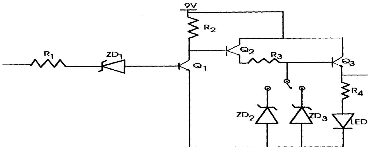
fig 2.1 (d) The switching circuit.
