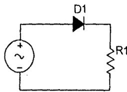
Fig 2.3a Half Wave Rectifier
