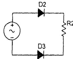
Fig 2.3b Full Wave Rectifier
