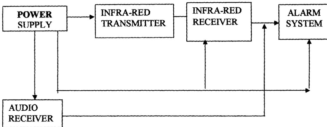
FIG 3.1 BLOCK DIAGRAM OF THE DUAL HOME SECURITY SYSTEM
