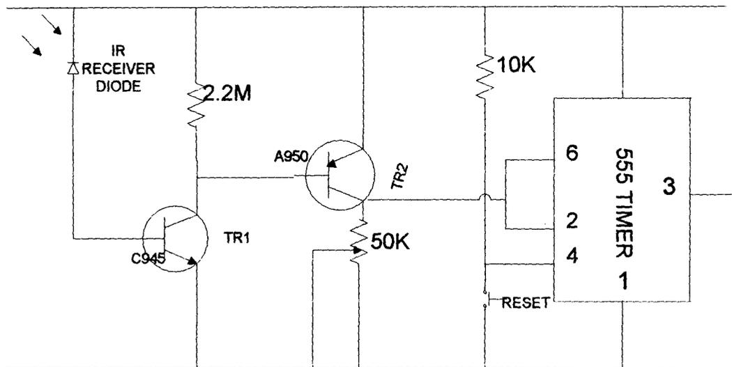
FIG. 3.6 RECEIVER CIRCUIT
