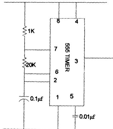
FIG 3.7 ALARM CIRCUIT.
