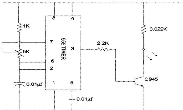
FIG 3.5 TRANSMITTER CIRCUIT
