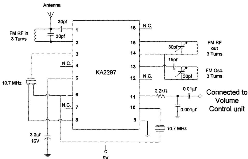
Fig 3.4.1.3.2 KA2297 Circuit
