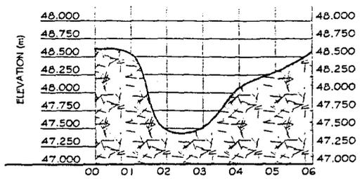
GULLY CROSS-SECTION AT CHAINAGE 0+020
