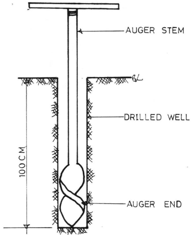
FIG 3:06 :- HAND DRIVEN AUGER
