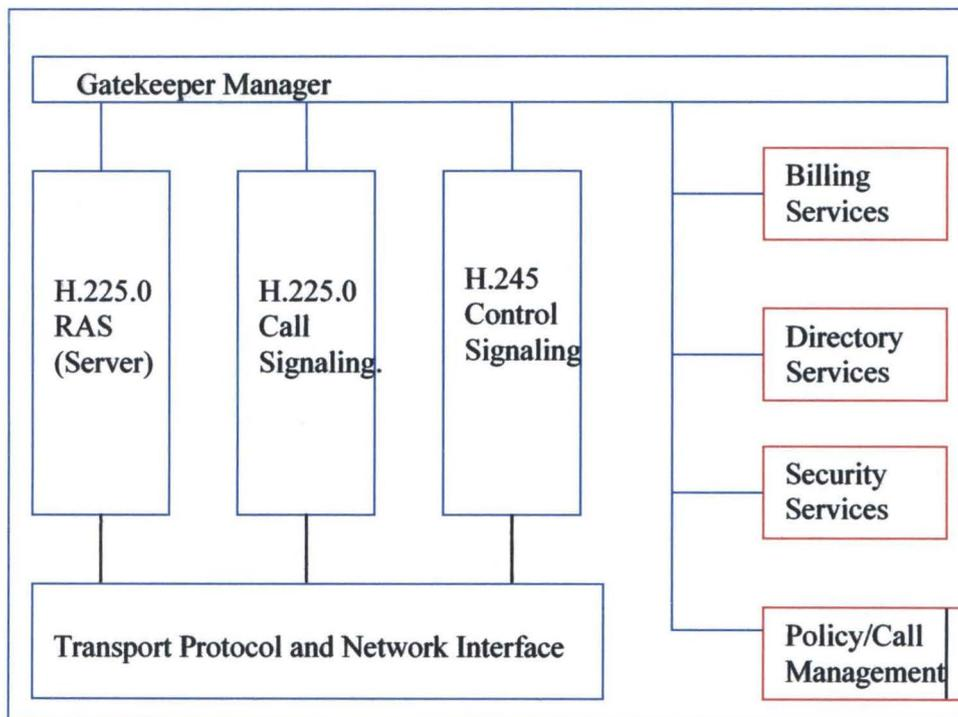
FIG.3.1.1 GATEKEEPER COMPONENTS
