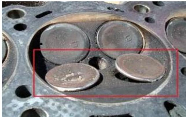
Plate XX: bent valve (www.ssch.com.au)
