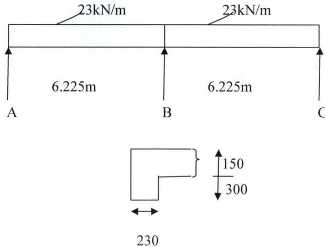
**Figure 4.3.1: BEAM 10****Loadings****Span AB & BC**
