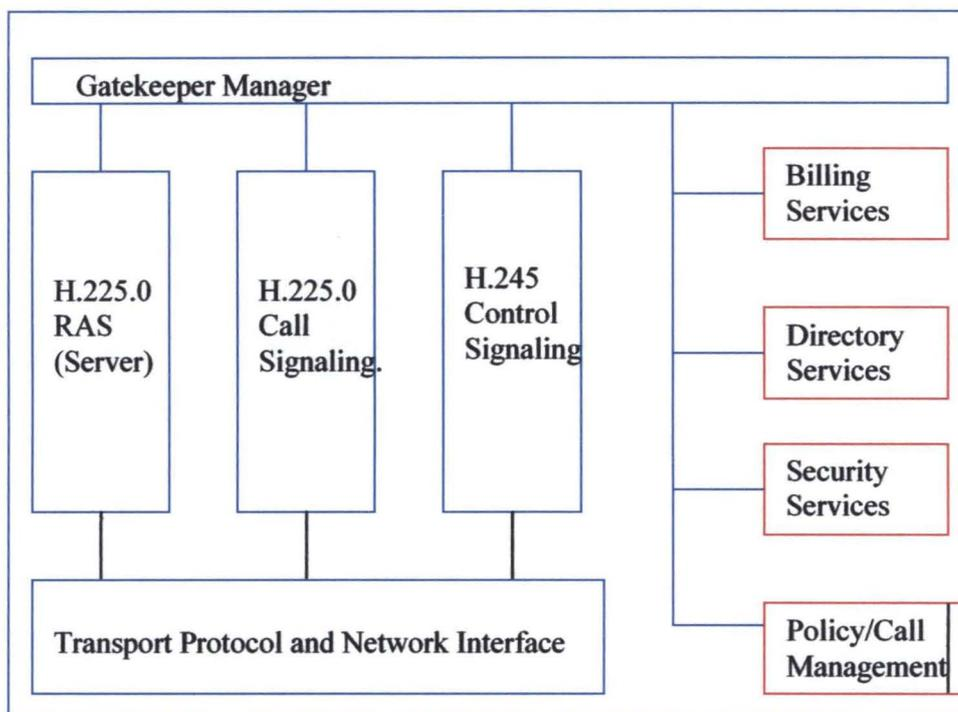
FIG.3.1.1 GATEKEEPER COMPONENTS
